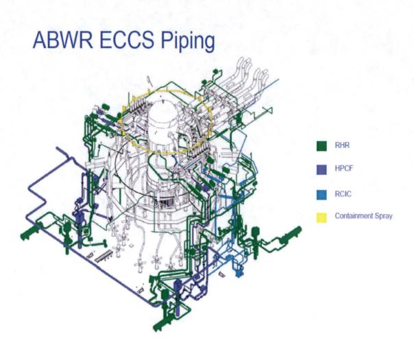
FIGURE A-2, LAYOUT OF ECCS COMPONENTS FOR DOWNSTREAM ASSESSMENT
