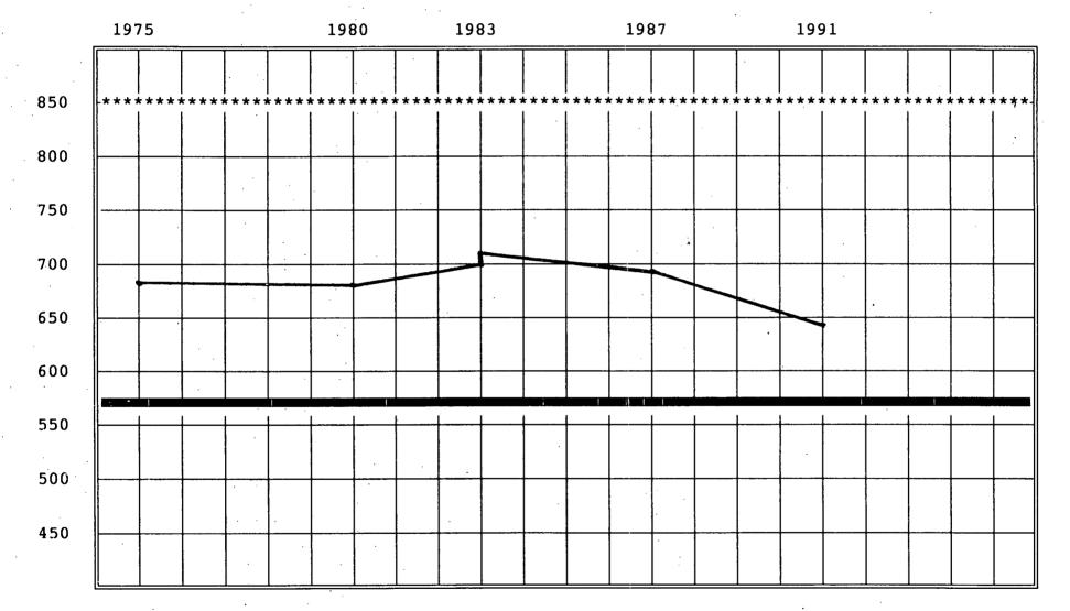
LIFT-OFF FORCE PER TENDON (KIPS) 53H10 AVERAGE LIFT-OFF FORCE PER WIRE (KIPS) 1D28
