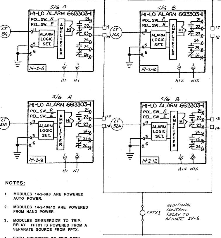
4. FPTX1 ENERGIZES TO TRIP BOTH MAIN FEEDWATER PUMP TURBINES THE MAIN TURBINE. FEEDWATER PUMP TURBINE TRIP CIRCUIT
