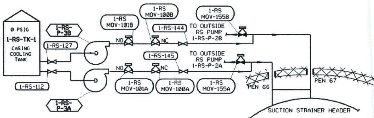
CONTAINMENT SUMP FILL FROM CASING COOLING TANK
