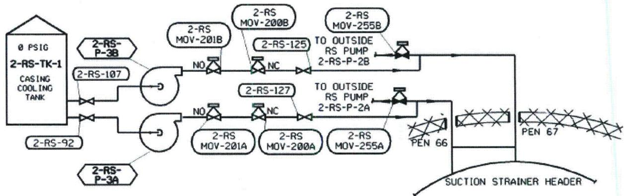
CONTAINMENT SUMP FILL FROM CASING COOLING TANK
