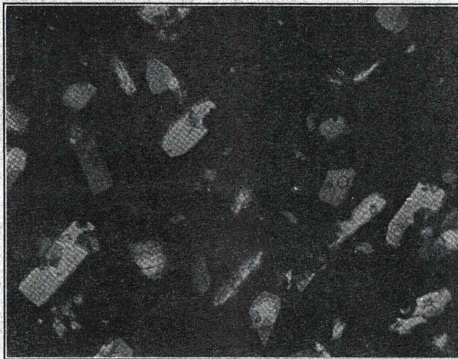
FIGURE 9.—*Synthetic*  $10\text{CaO}\cdot 5\text{SiO}_2\cdot 6\text{H}_2\text{O}$ .
