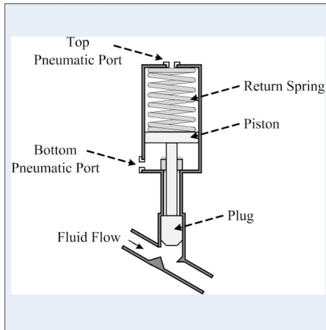
**FIGURE 4-1 PNEUMATIC VALVE**
