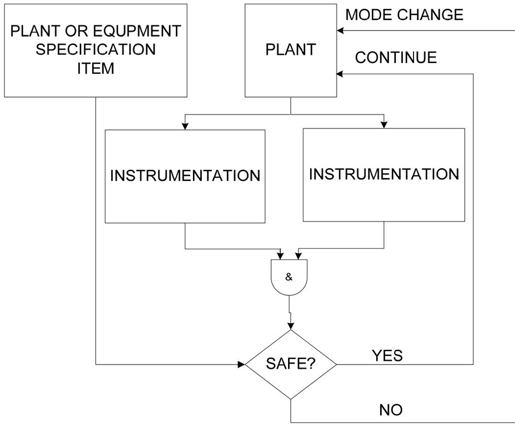
**FIGURE 2-8 PHYSICAL REDUNDANCY**
