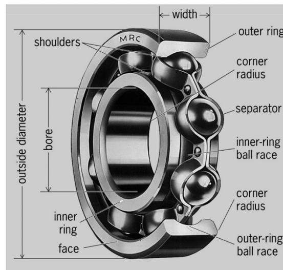
**FIGURE 4-3 PARTS OF ROLLING ELEMENT BEARING<sup>5</sup>**
