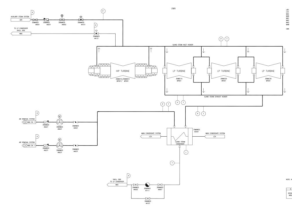
AUXILIARY STEAM PIPING SYSTEM MAIN CONDENSATE PIPING SYSTEM HP STEAM TURBINE IP TURBINE LP STEAM TURBINE CONDENSING SYSTEM VENT SYSTEM FOR AR REMOVAL SYSTEM TURBINE GLAND STEAM SEALING SYSTEM
