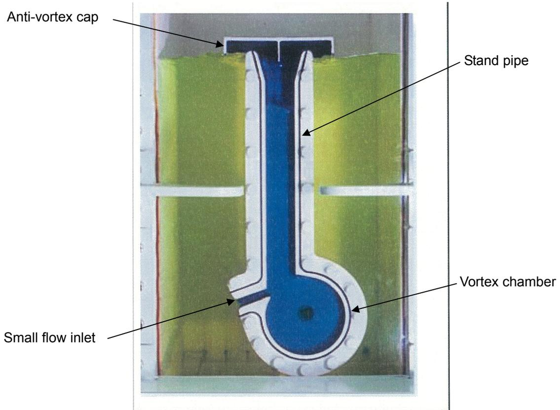
**Photo. 4.2.1-1 1/8.4 Scale Test Apparatus**
