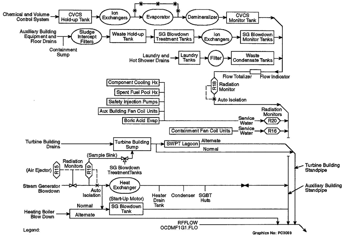
LIQUID RADIOACTIVE EFFLUENT FLOW DIAGRAM
