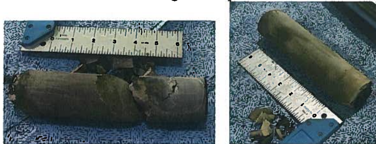
Figures of the Cores, Left (slow pour) and Right (fast Pour)
