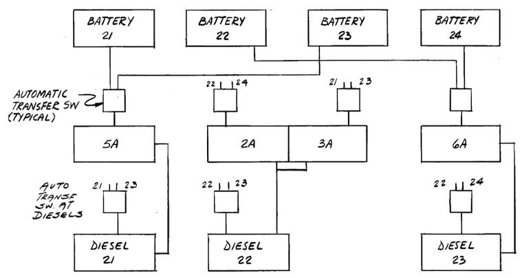
480 VOLT SYSTEM CHANNELIZATION OF D.C. CONTROL POWER
