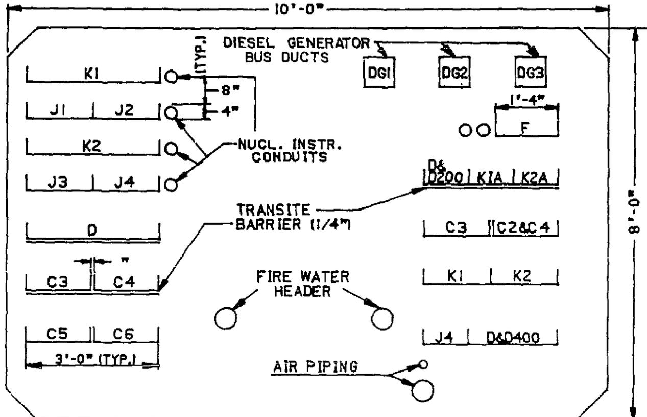
**TYPICAL SECTION-CABLE TUNNEL**
