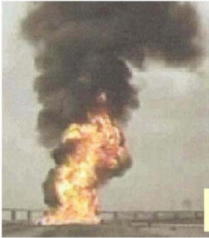
Montour - 35 m LNG pool fire
