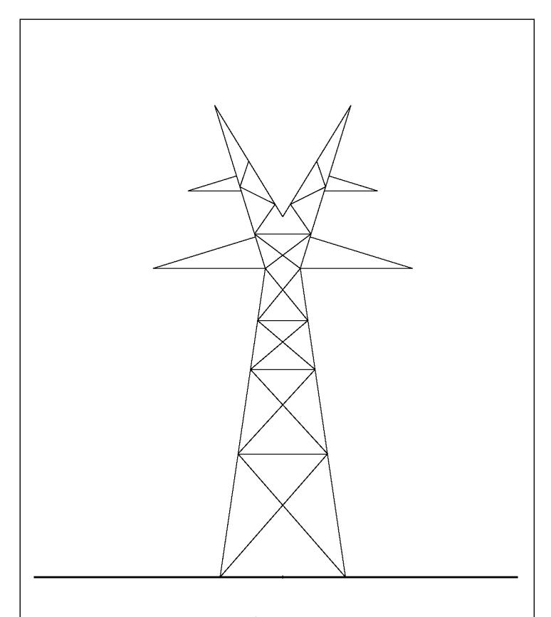
TYPICAL 345 KV V TYPE TOWER TANGENT TOWER
