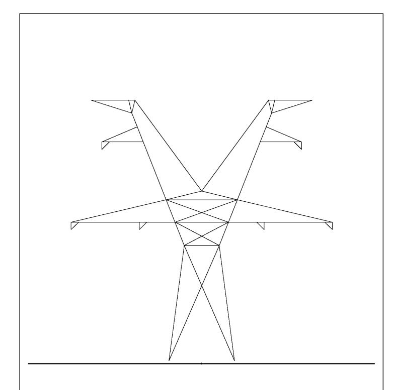
TYPICAL 345 KV V TYPE TOWER 10-DEG ANGLE TOWER
