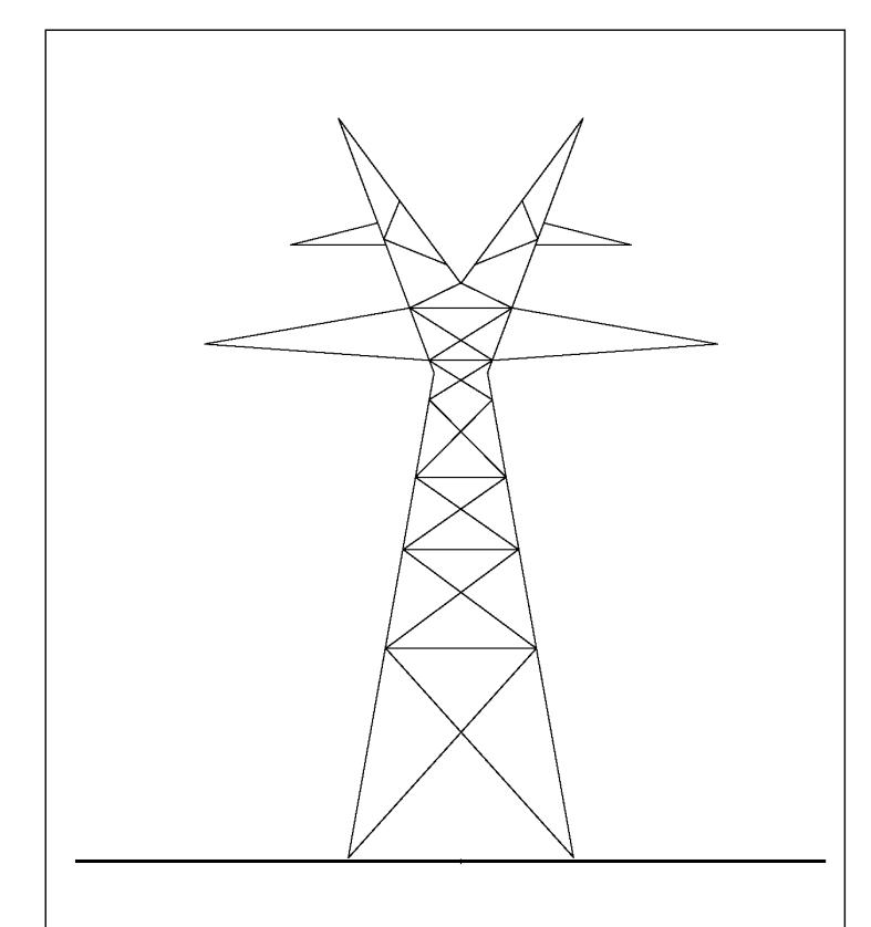
TYPICAL 345 KV V TYPE TOWER 5-DEG TOWER
