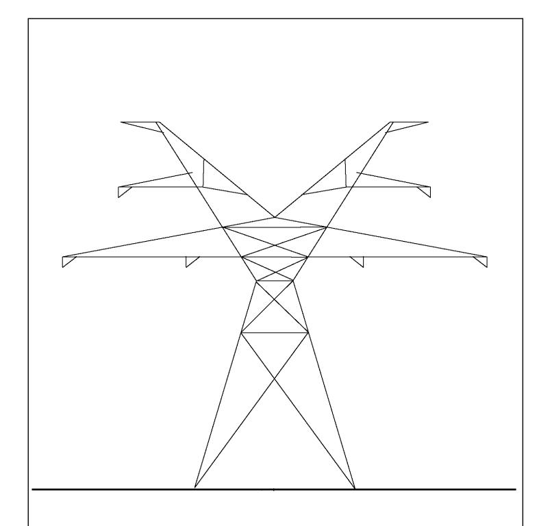
TYPICAL 345 KV V TYPE TOWER 25-DEG ANGLE TOWER
