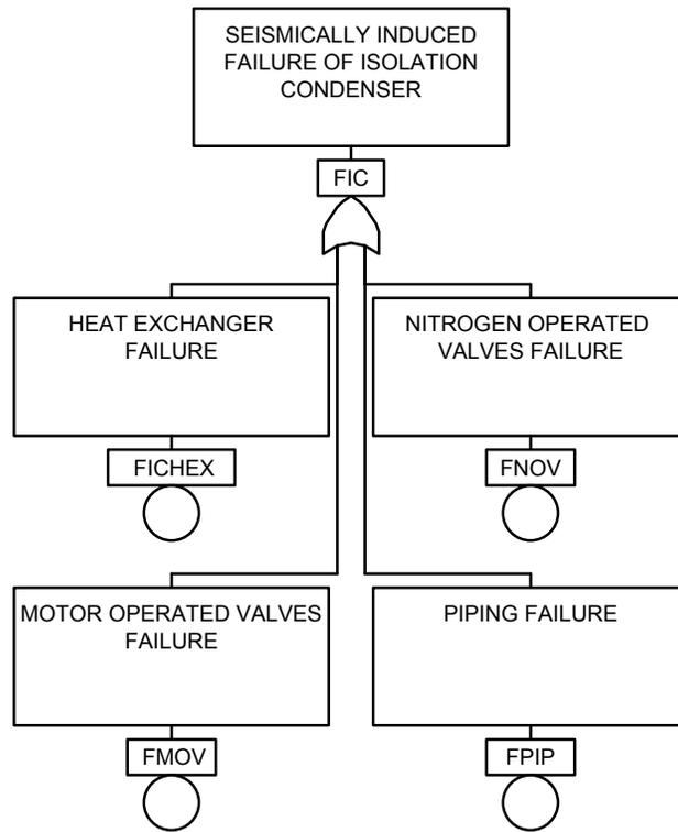
**Figure 15-9. IC Seismic Fault Tree**
