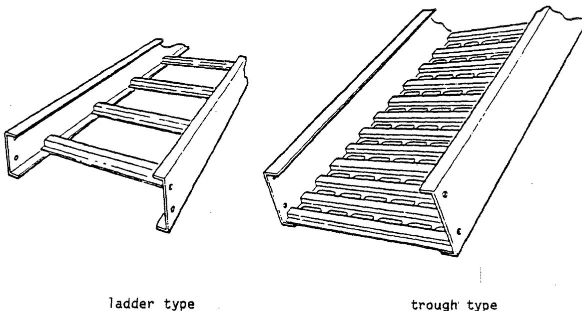
Figure 2. Cable Trays<sup>4</sup>
