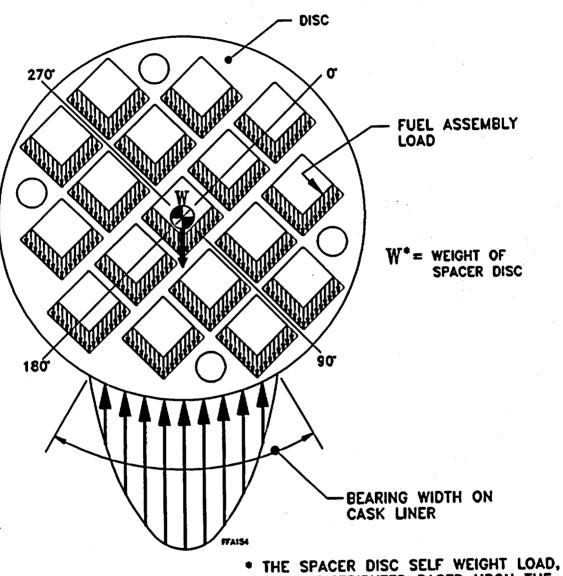
• THE SPACER DISC SELF WEIGHT LOAD, W, IS DISTRIBUTED BASED UPON THE MODEL GEOMETRY. THE FIGURE IDEALIZES THE LOAD AT THE SPACER DISC C.G. FOR SIMPLIFICATION.
