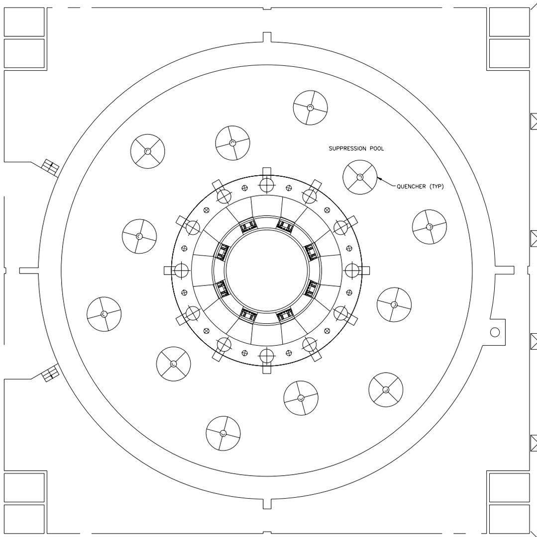
**Figure 5.2-3. Safety-Relief Valve Discharge Line Quencher Arrangement**
