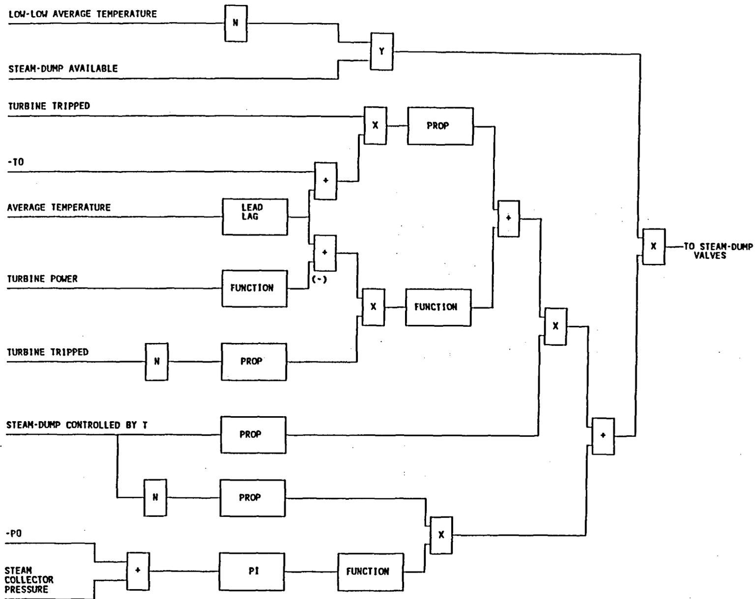
FIGURE. 4 STEAM-DUMP CONTROL SYSTEM
