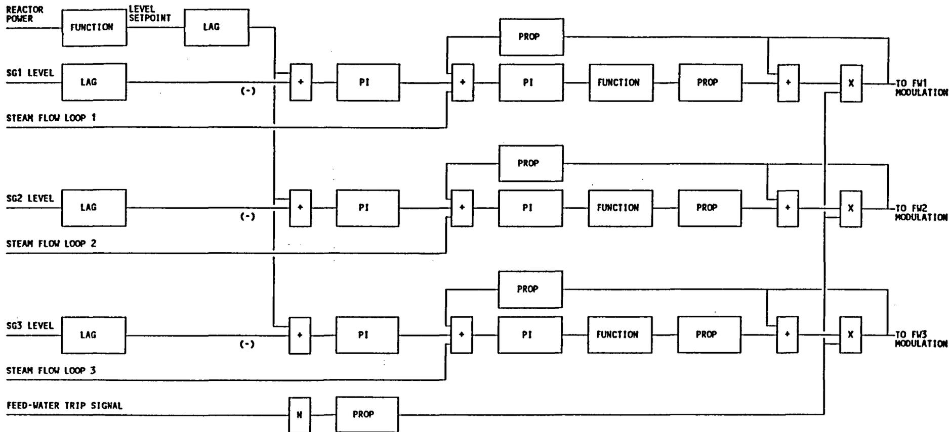
FIGURE 3. FEED-WATER CONTROL SYSTEM
