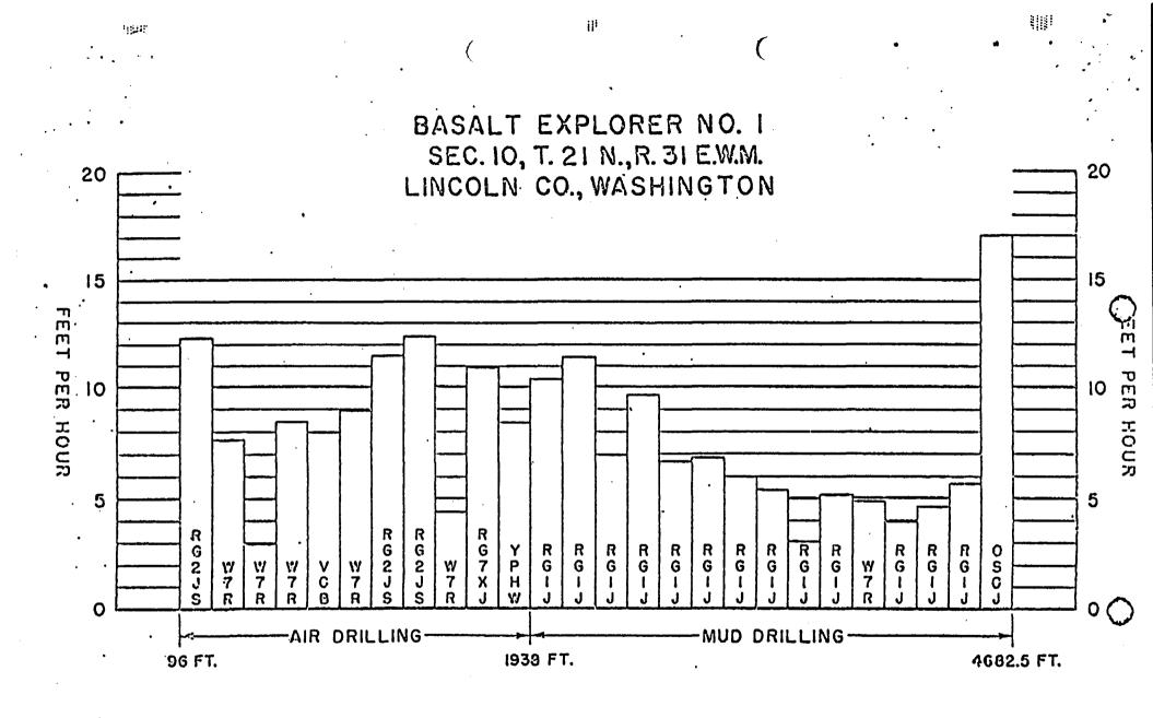
PLATE 5. DRILL BIT FOOTAGE PER HOUR
