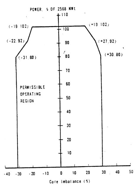
OPERATIONAL POWER IMBALANCE ENVELOPE FOR OPERATION FROM 0 TO 390 + 10 EFPD UNIT 2 - 30
