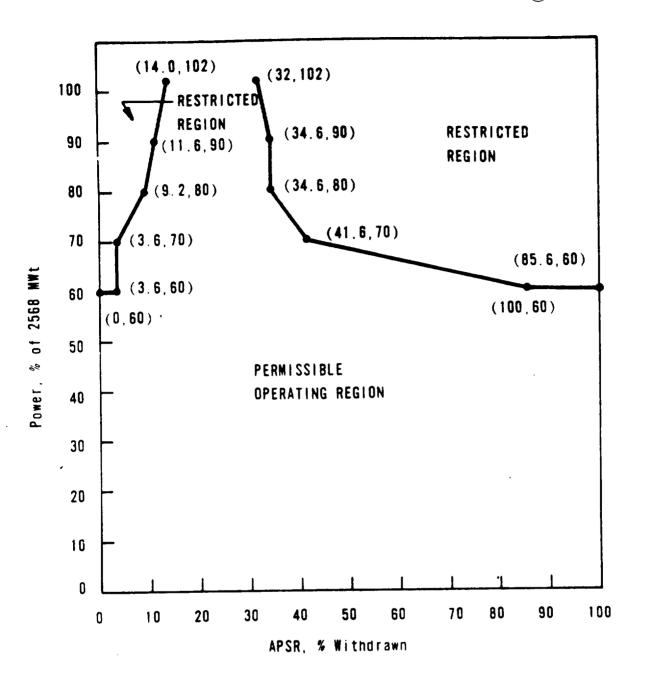
APSR POSITION LIMITS FOR OPERATION FROM 100 (±10) TO 235 (±10) EFPD, UNIT 1
