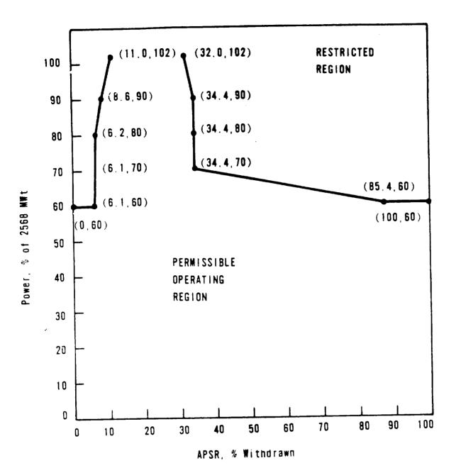
APSR POSITION LIMITS FOR OPERATION AFTER 235 (±10) EFPD, UNIT 1
