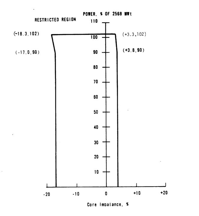
OPERATIONAL POWER IMBALANCE ENVELOPE FOR OPERATION FROM 100 (±10) TO 235 (±10) EFPD, UNIT 1 OCONEE NUCLEAR STATION Figure 3.5.2-3A2
