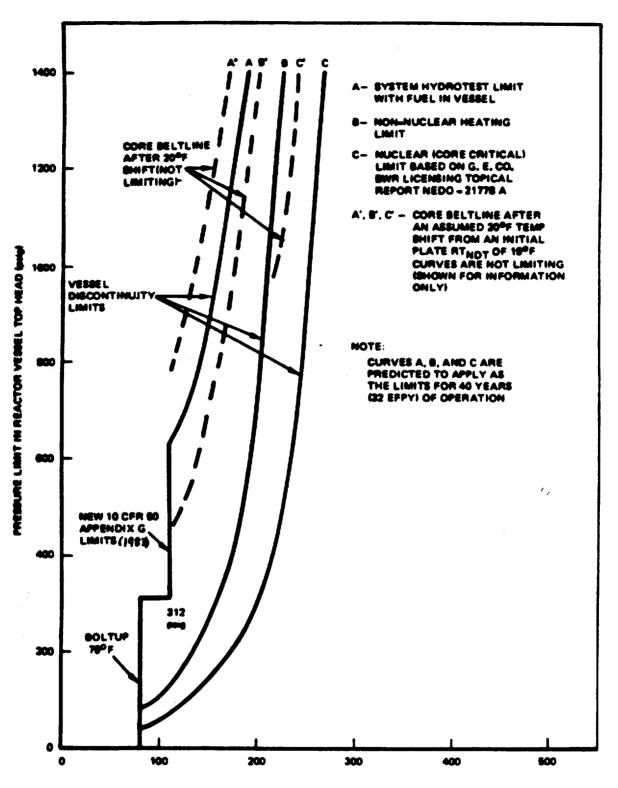
MINIMUM REACTOR VESSEL METAL TEMPERATURE (°F)
