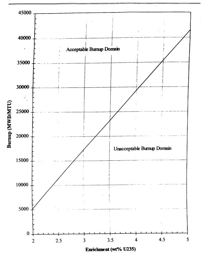
FIGURE 5.6-1 BURNUP VERSUS ENRICHMENT FOR PWR FUEL
