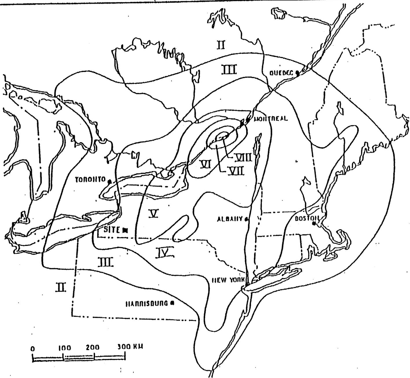
ISOSEISMAL MAP OF THE CORNWALL-MASSENA EARTHQUAKE
