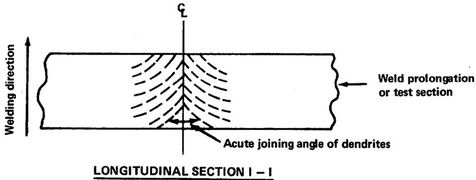
**WELD CROSS-SECTION SHOWING SOLIDIFICATION PATTERN AND CHARPY TEST SPECIMENS**
