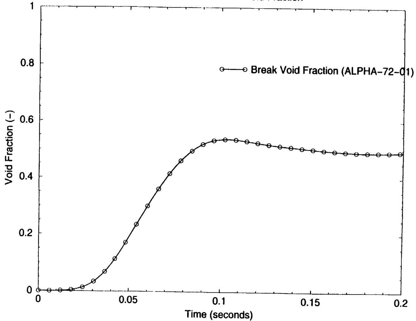
Figure 12: Upstream Break Void Fraction (0-0.2 sec)
