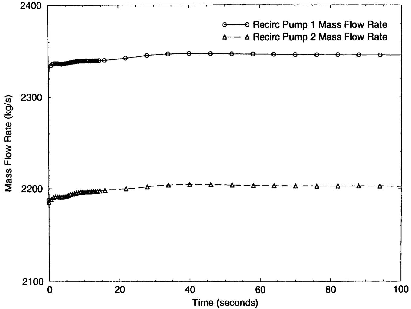
Figure 34: Recirculation Pump 1 and 2 Mass Flow Rates (0-100 sec)
