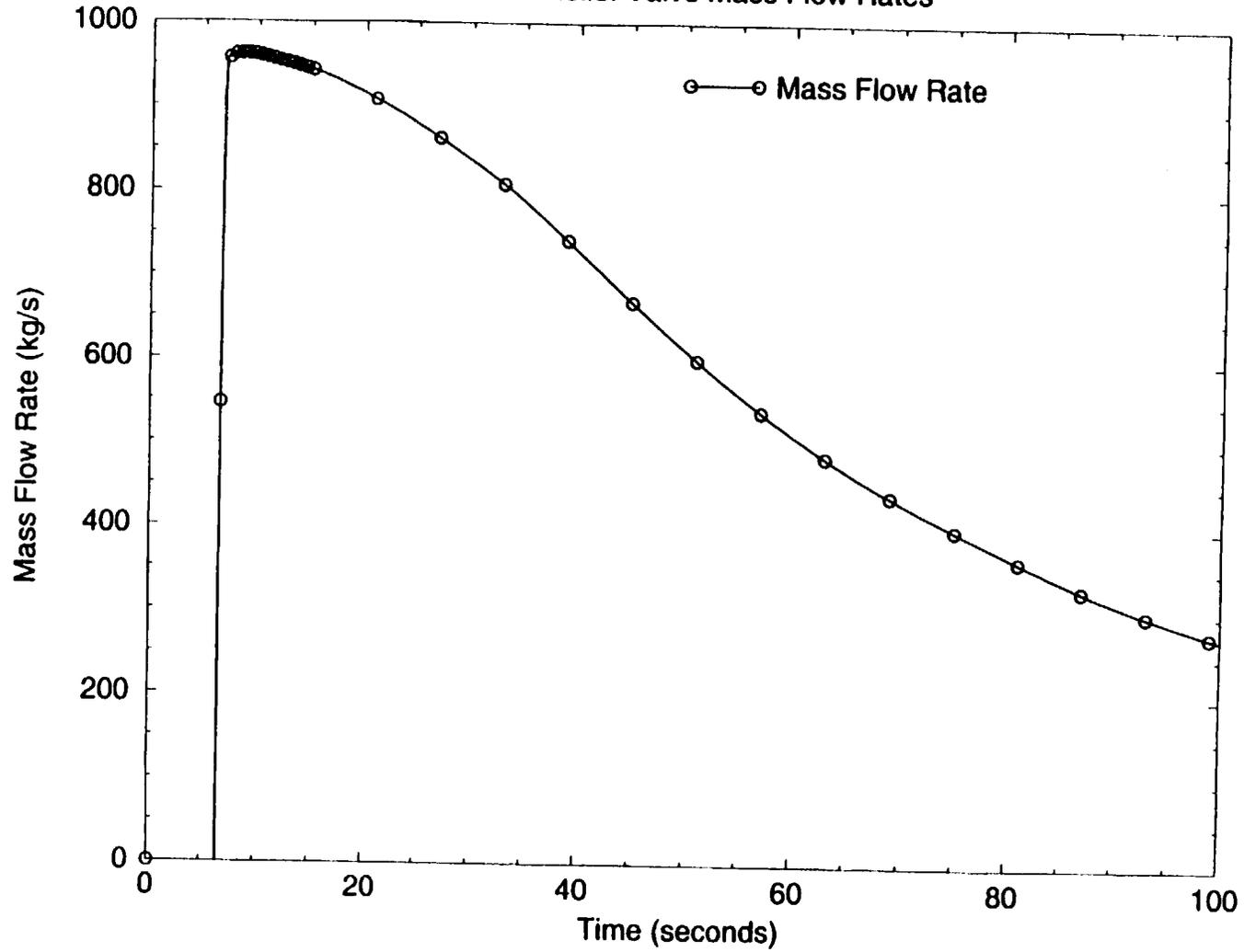
Figure 22: Steam Relief Valve Mass Flow Rate (0-100 sec)
