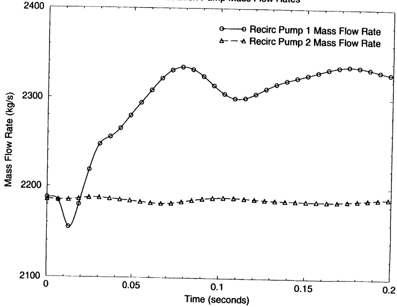
Figure 33: Recirculation Pump 1 and 2 Mass Flow Rates (0-0.2 sec)
