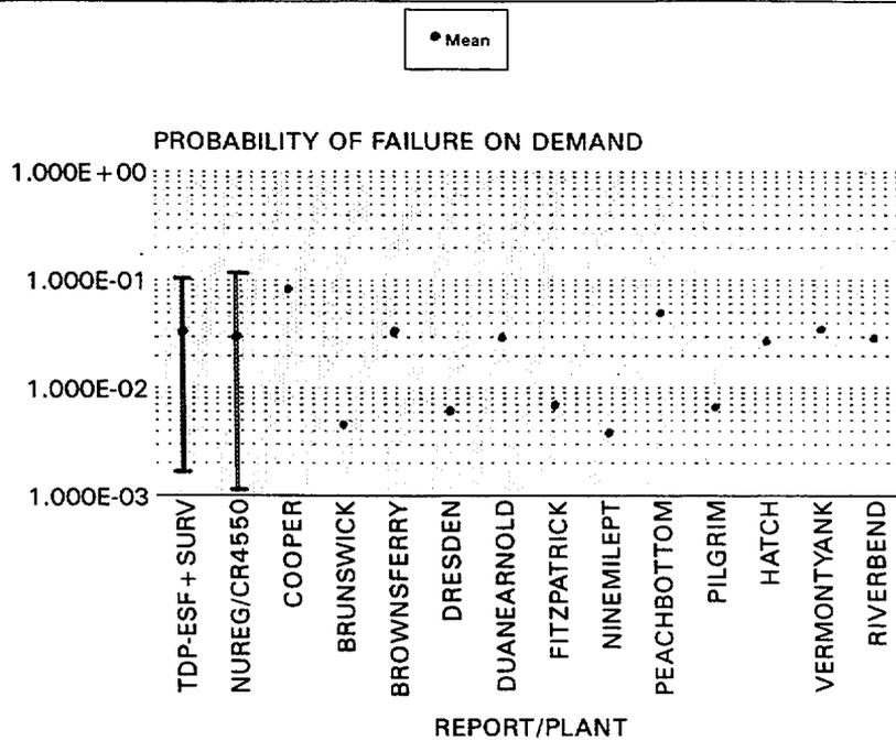
**BWR HPCI SYSTEM TDP PROBABILITY OF FAILURE ON DEMAND
