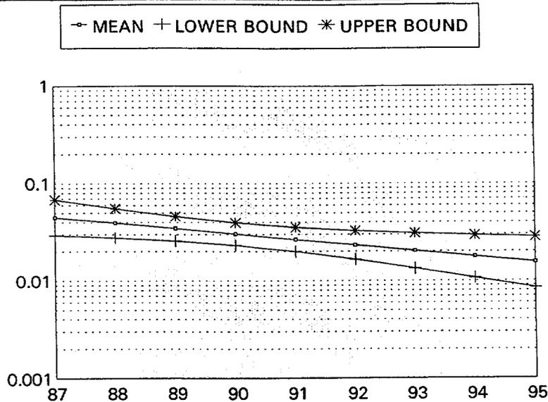
**BWR HPCI SYSTEM TDP PROBABILITY OF FAILURE ON DEMAND
