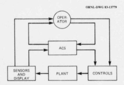
Fig. 2.10. A hierarchical control system.
