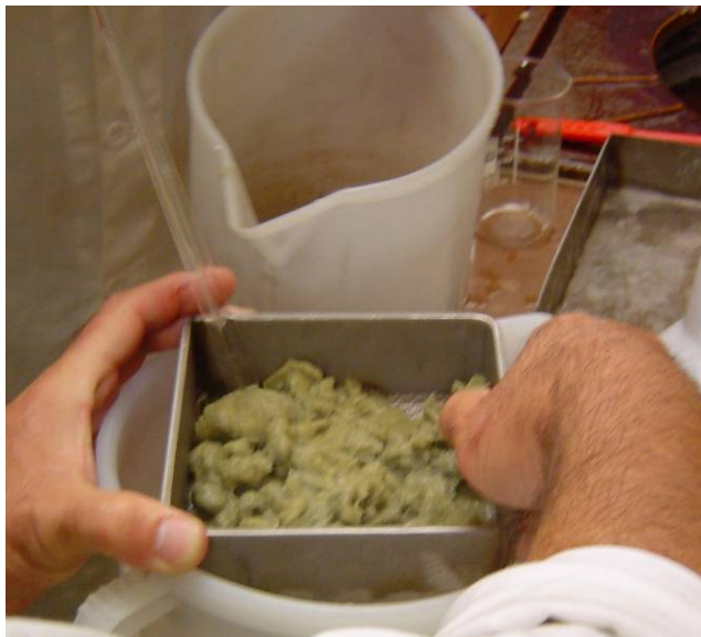
Figure 6: Pre-Test Pour of Loop 3 Debris Slurry
