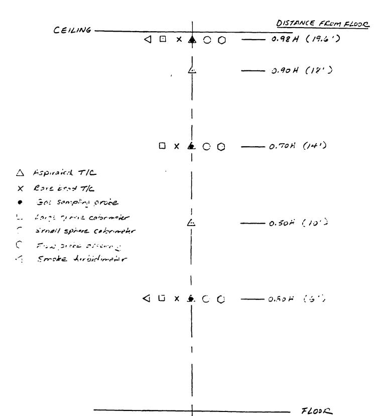
FIGURE B-2 INSTRUMENTATION LAYOUT - SECTOR CONFIGURATION
