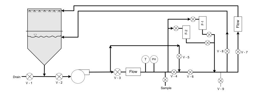
$Figure\ 1-Test\ Loop\ Process\ Flow\ Diagram$
