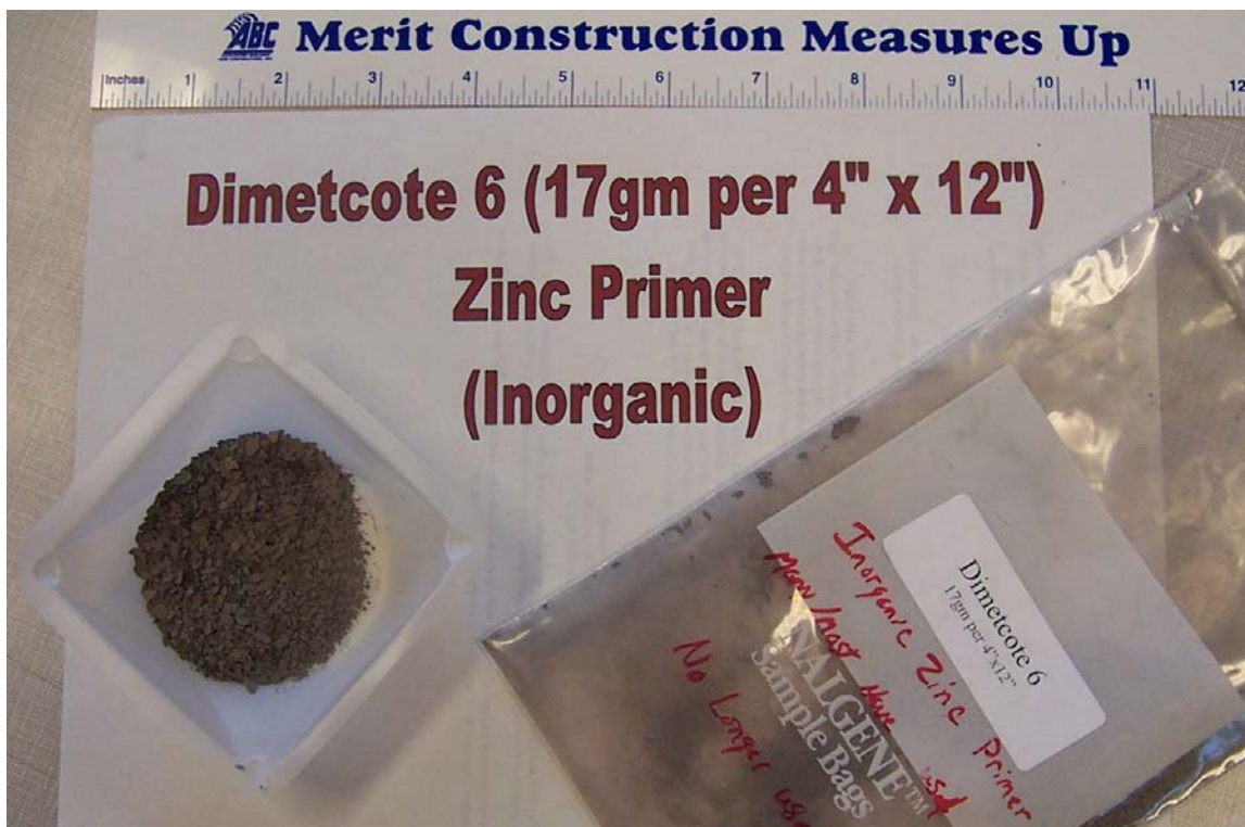
Fig. 5-3. Zinc primer before test.
