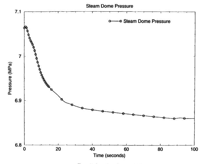
Figure 30: Steam Dome Pressure (0-100 sec)
