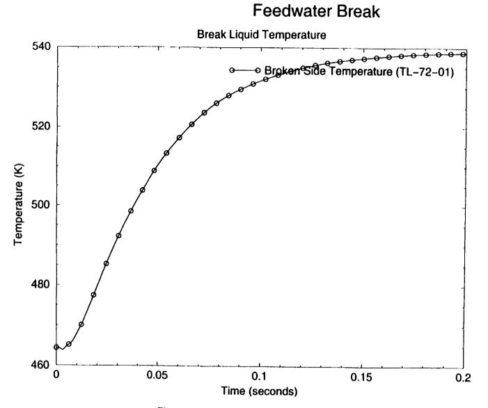
Figure 10: Upstream Break Temperature (0-0.2 sec)
