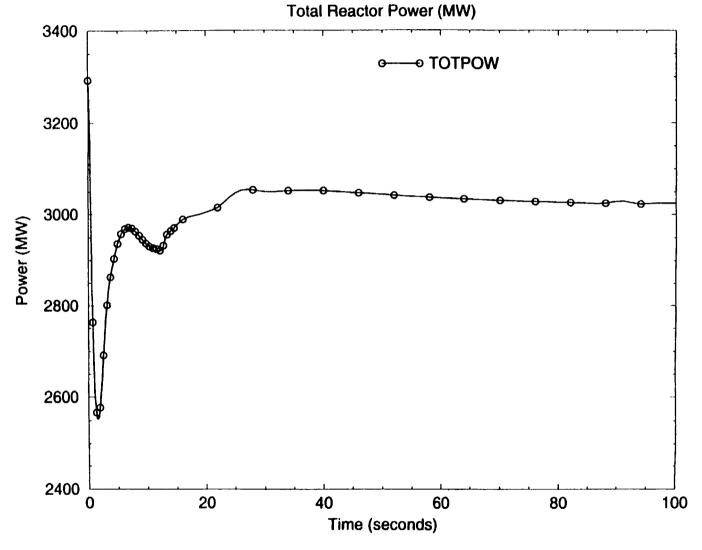
Figure 28: Total Reactor Power (0-100 sec)
