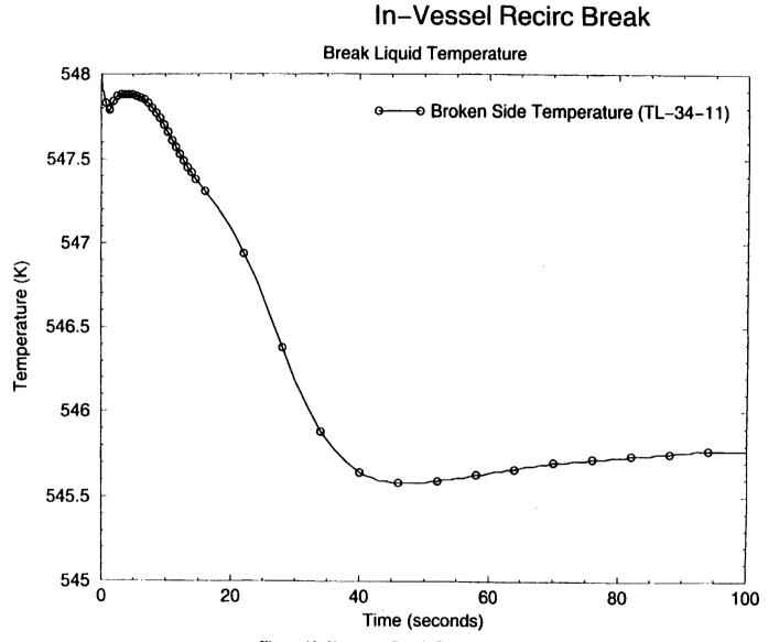
Figure 12: Upstream Break Temperature (0-100 sec)
