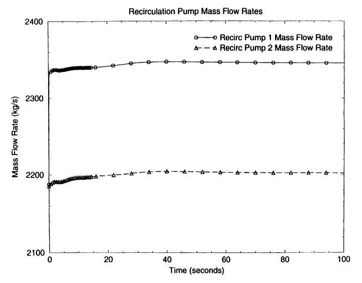
Figure 34: Recirculation Pump 1 and 2 Mass Flow Rates (0-100 sec)
