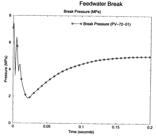
Figure 8: Upstream Break Pressure (0-0.2 sec)
