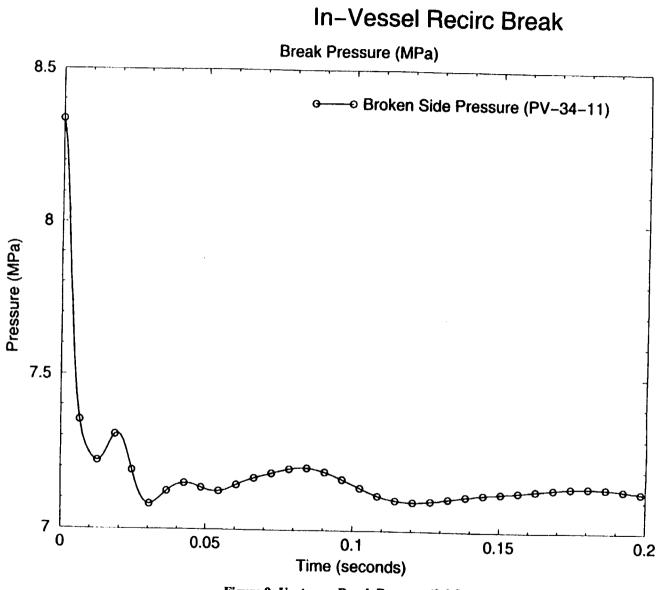
Figure 9: Upstream Break Pressure (0-0.2 sec)
