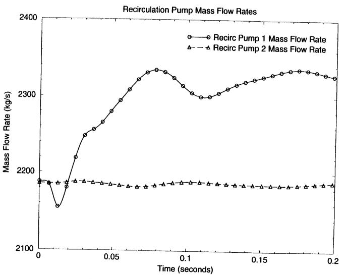
Figure 33: Recirculation Pump 1 and 2 Mass Flow Rates (0-0.2 sec)
