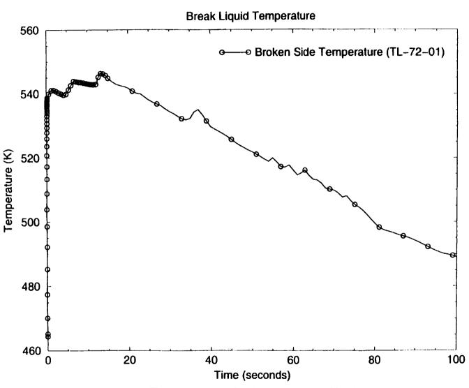
Figure 11: Upstream Break Temperature (0-100 sec)
