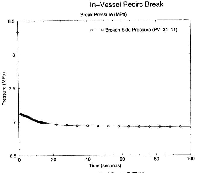
Figure 10: Upstream Break Pressure (0-100 sec)
