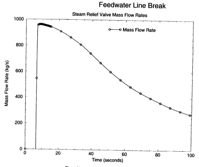
Figure 22: Steam Relief Valve Mass Flow Rate (0-100 sec)
