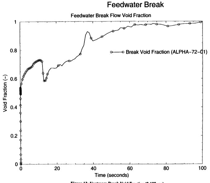
Figure 13: Upstream Break Void Fraction (0-100 sec)
