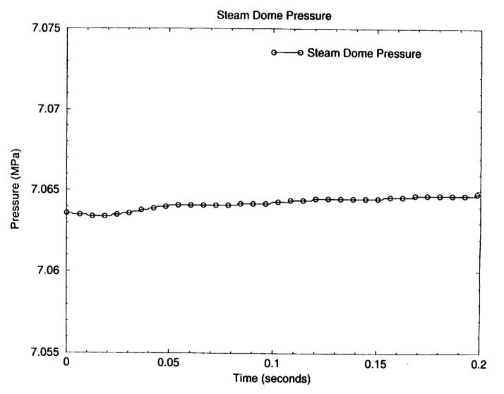
Figure 29: Steam Dome Pressure (0-0.2 sec)
