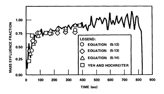
Figure B-19. Mass Effluence, Run 31922
