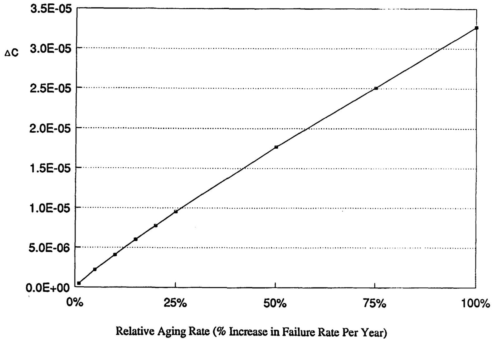
**FIGURE 12. CORE DAMAGE FREQUENCY INCREASE FOR A PLAUSIBLE RANGE OF AGING:
