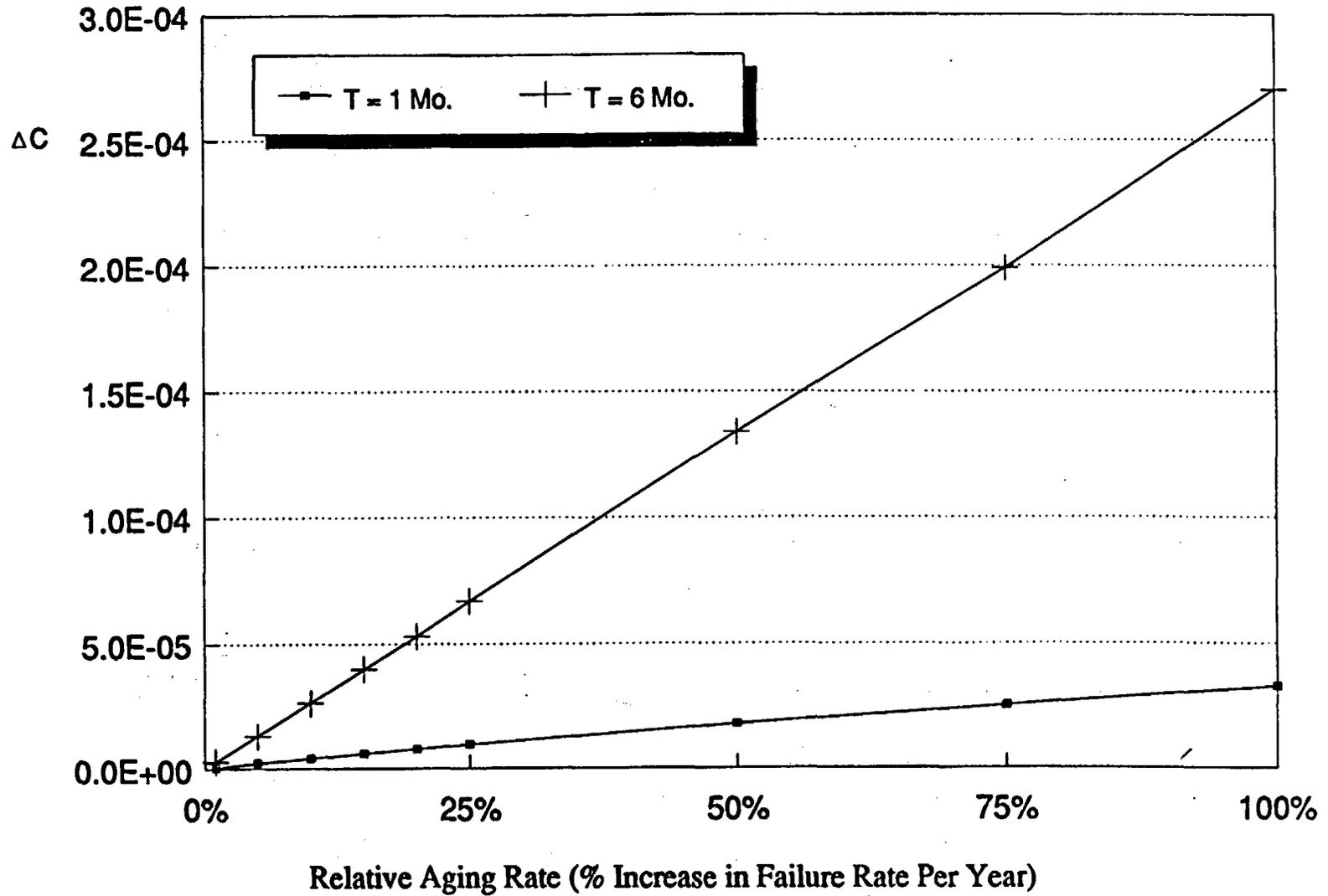
**FIGURE 13. CORE DAMAGE FREQUENCY INCREASE FOR A PLAUSIBLE RANGE OF AGING:
