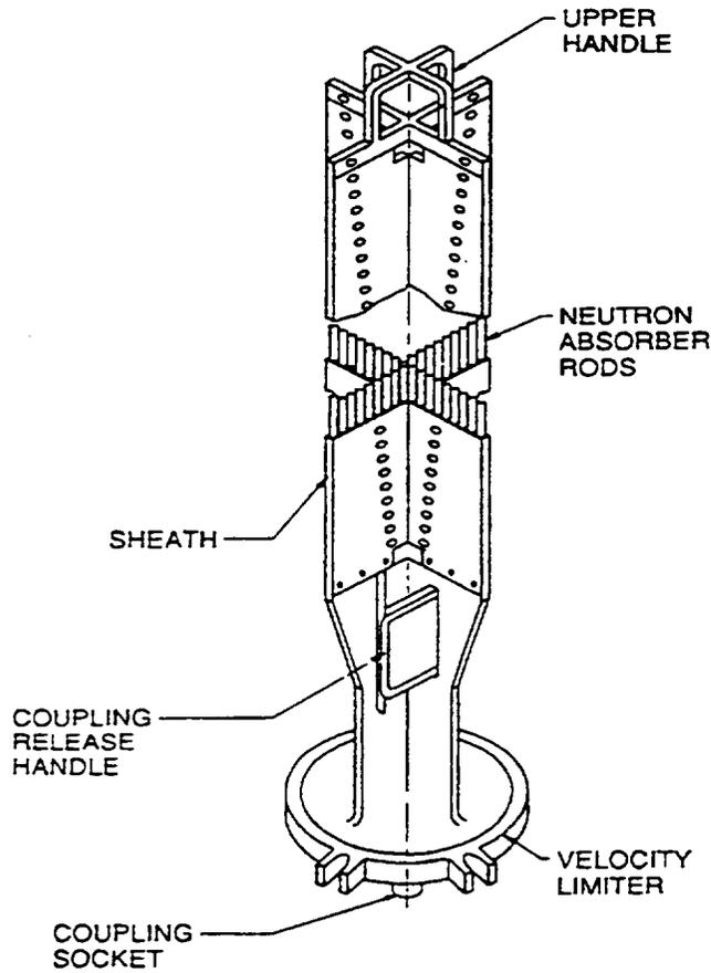
Figure 2-7. Control rod (blade).
